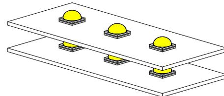
图2. 安装电路板的不适当摆放例
